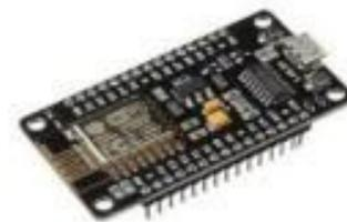
Gambar 2. NodeMCU ESP8266
