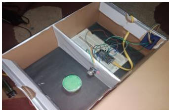
Gambar 4.1 hardware sistem deteksi kebakaran
