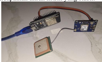
Gambar 3 GPS Neo-6m yang terhubung pada ESP32
