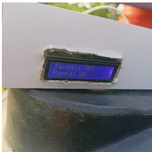
Gambar 8. Monitoring Ketinggian Menggunakan LCD
