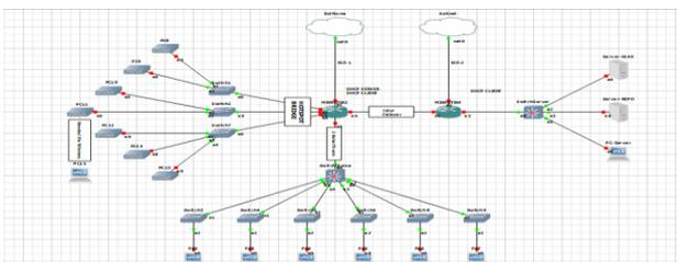
Dalam hal ini peneliti membagi segmen ke dalam 6 VLAN yaitu VLAN 10 untuk BAUK, VLAN 20 untuk UPM, VLAN 30 untuk BKK, VLAN 40 untuk Balai Bahasa, VLAN 50 untuk LAB, dan VLAN 99 untuk lainnya. Berikut adalah topologi yang di buat dan pembagian VLAN. Dapat dilihat pada gambar - Pembagian VLAN.
