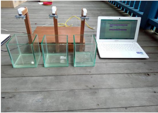
Gambar 4.5 Prototipe Monitoring Ketinggian Banjir Berbasis Komputer
