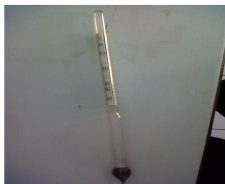
**Gambar 1 Beome (alat bantu mengetahui konsentrasi larutan)**
