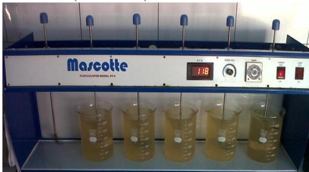
**Gambar 3 Alat menganalisa dosis *aluminium sulfat***
