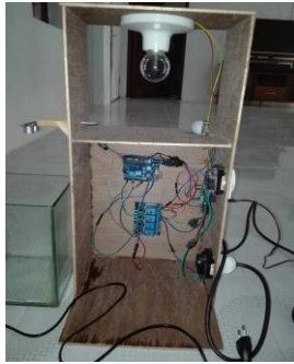
Gambar 4.6 Desain Alat Sistem Kendali Bak Penampung Air dan Lampu
