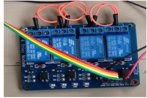
Gambar 4.2 Relay Yang Telah Dipasang Kabel
