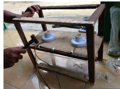
Gambar Pemasangan Kabel dan Fitting Lampu
