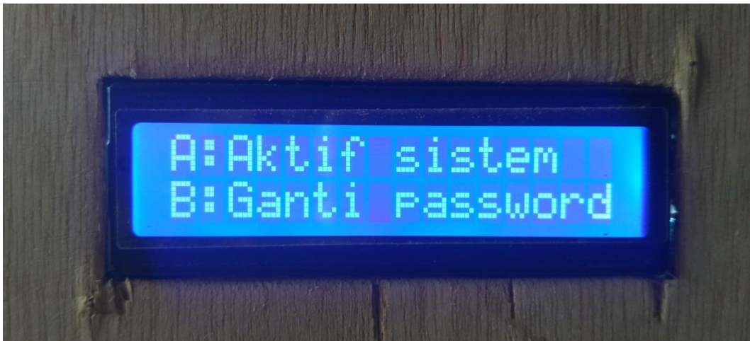
Gambar 4.9 LCD 16x2 dengan Serial I2C
